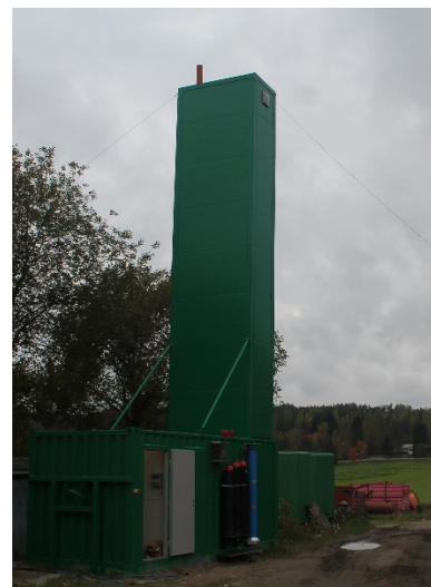
KUVA 6. Uudella biokaasupuhdistamolla päästään jopa 99 % CH 4 puhtauteen.
