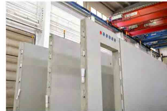
Seläntelementtejä. Elementtien tuotanto on nyt pohjamudissa, koska asuntoja rakennetaan vähän. KUVA: TEHTEL OY
